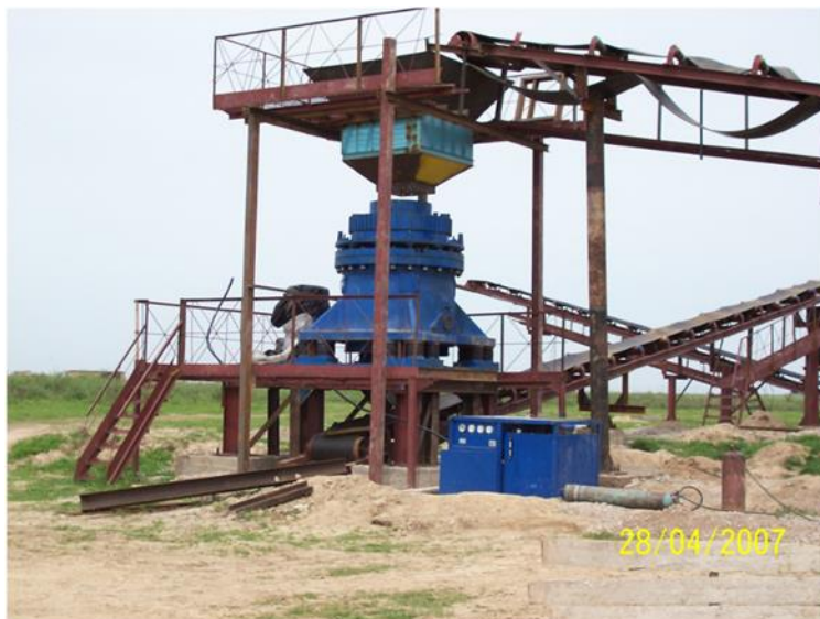
Рисунок 6. Дробильно-сортировочная установка на базе КИД-1200М
