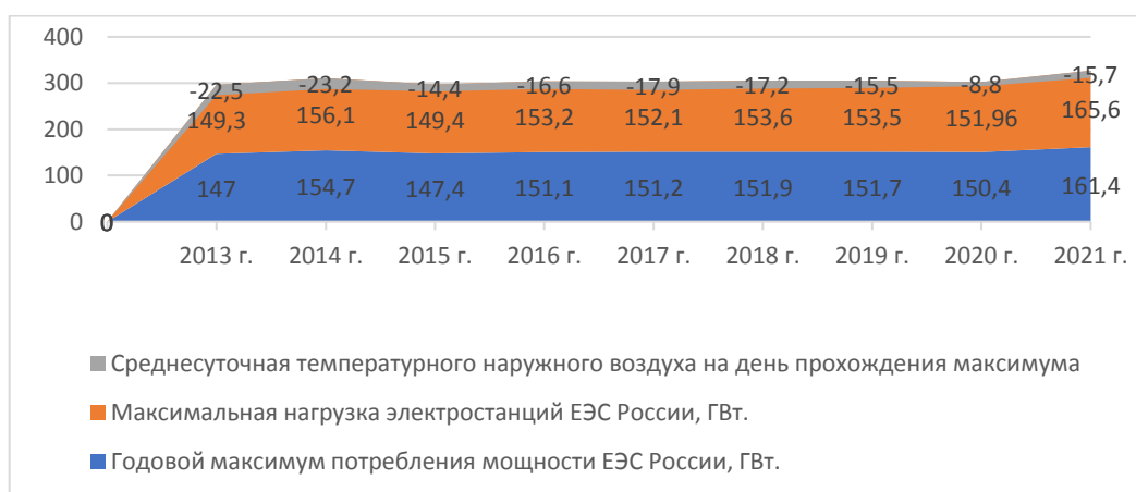
Рисунок 19– Сопоставление температурного режима с годовым максимумом потребления электроэнергии и нагрузки электростанций
