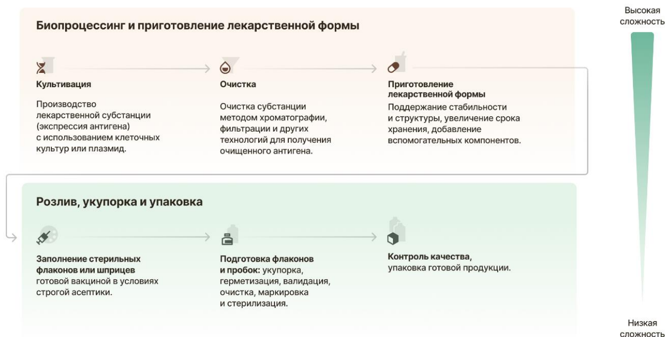
Рисунок 2.2 – Упрощённая схема производства вакцин
