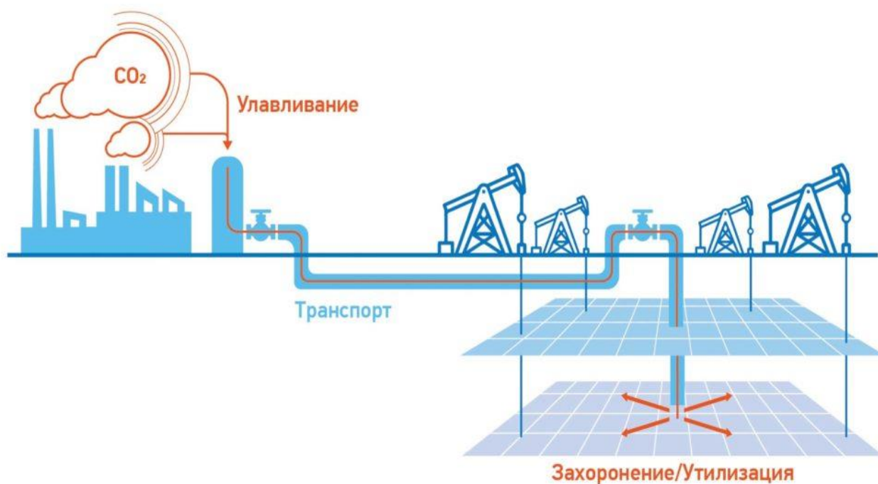
Рисунок 4.6 – Схематичное изображение технологии улавливания, утилизации и захоронения углекислого газа (CCUS) 270
